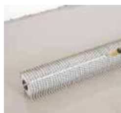
Odvzdušněte povrch jehlovým válečkem
