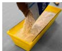
Nasypejte 2,5 kg ROKOPLASTU do 1 litru vody
